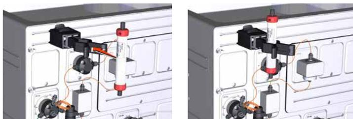
3 将合适的管连接到柱阀端口，在本示例中为端口 1A。
